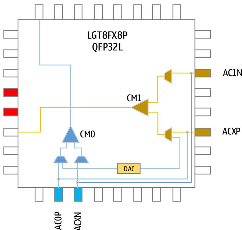
LGT8FX8P 比较器 0/1 的控制寄存器命名有所改变。控制寄存器分别为 COSR/C1SR。控制比较器输出以及输出数字滤波的寄存器为新增寄存器 COXR/C1XR。
